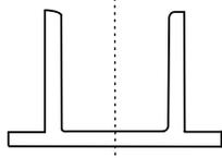
Профили прессованные прямоугольные таврошвеллерного сечения из алюминиевых сплавов ГОСТ 17575-90.
