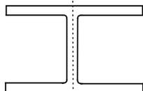
Профили прессованные прямоугольные равнополочного двухтаврового сечения из алюминиевых сплавов ГОСТ 13621-90.
