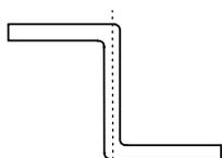
Профили прессованные прямоугольные равнополочного зетового сечения из алюминиевых сплавов ГОСТ 13620-90.
