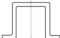
Профили прессованные прямоугольные таврошвеллерного сечения из алюминиевых сплавов ГОСТ 17575-90.
